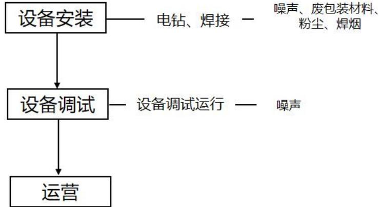
图 2-2 施工期工艺流程图
