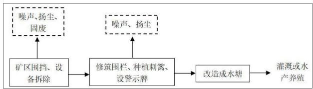
图 4.3-1 开采区闭坑期工艺流程图
