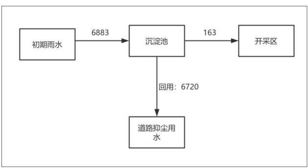
图 4-1 本项目水平衡图 (m³/a)
