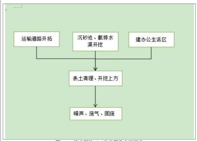
图4.1-1 基建期施工工艺流程及产污环节
