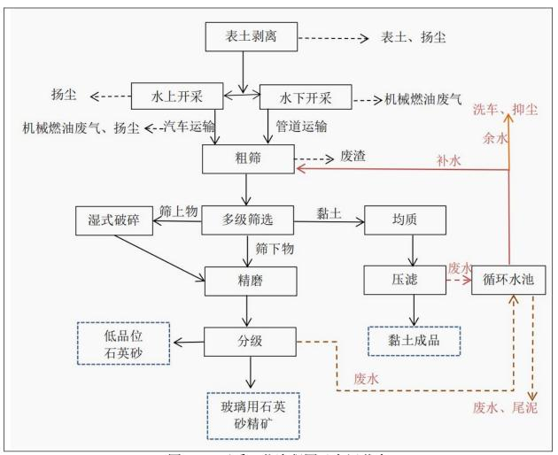
图4.2-1 开采工艺流程图及产污节点
