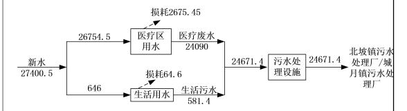
图 2-1 本扩建项目水平衡图 (单位: m³/a)
