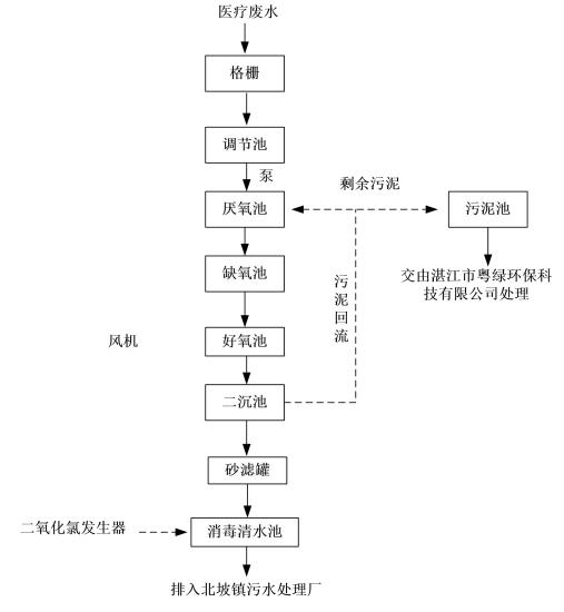
图 4-1 废水处理工艺流程图
