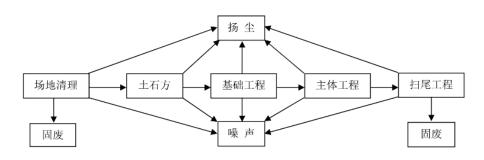
图 2-2 施工期工艺流程图
